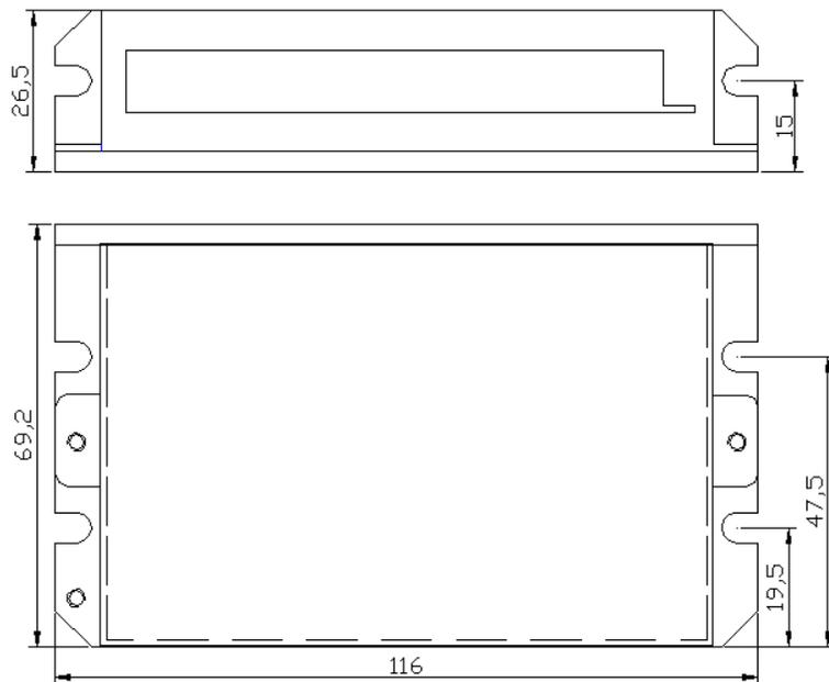
※推荐采用侧面安装，散热效果更佳，设计安装尺寸时，注意考虑端子大小及布线！
