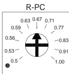
峰值电流衰减比率设置 R-PC: 该内置式电位器用来设置驱动器实际峰值电流与标称峰值电流的比率, 范围 0.5~1.0。通过调节该比率以适应不同的电机和应用。驱动器的峰值电流设定值  $I_p \geq 4 \cdot P_2 / V_p$ , 其中  $P_2$  为电机额定输出功率 (W),  $V_p$  为额定驱动电压 (V)
